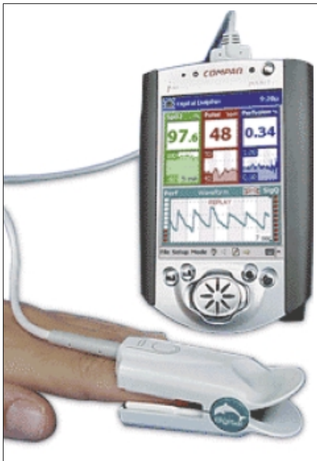
Fig. 1. Pulsioxímetro integrado en una PDA.
